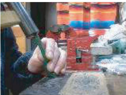
②、①の状態から手元を動かさず、上下、左右の順にポンチを少し傾けて打刻します。文字がズレないように、ポンチを軽く押さえながら浮かせないように注意してください。
